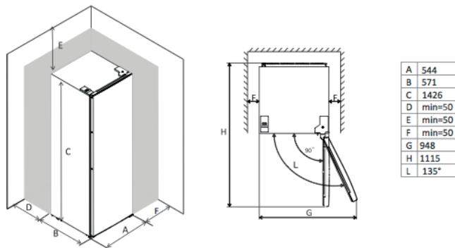
Для комфорного використання приладу забезпечте простір для відкривання дверей. Для уникнення вібрацій та відповідної вентиляції приладу, під час встановлення, залиште 5см простору з бокових сторін приладу.
